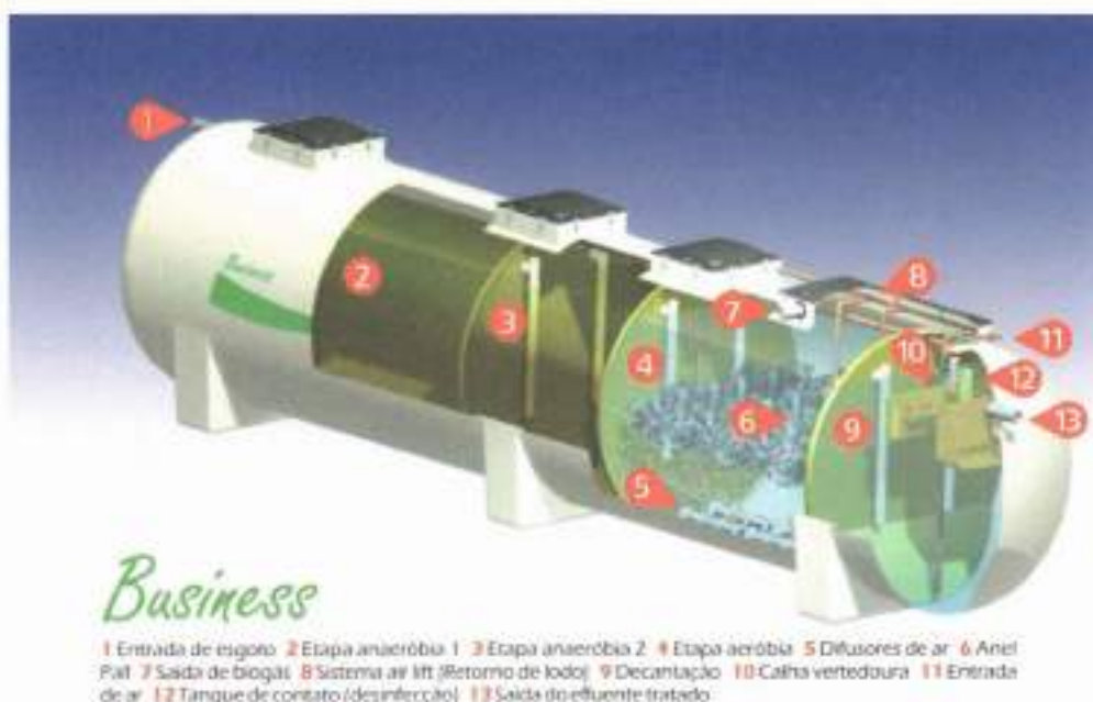
Figura 9 - Exemplo de Estação de Tratamento de Esgoto Compacta.
